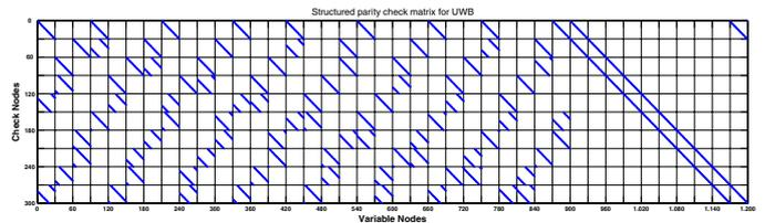
Fig. 3. The Ultra-Sparse UWB LDPC Code
